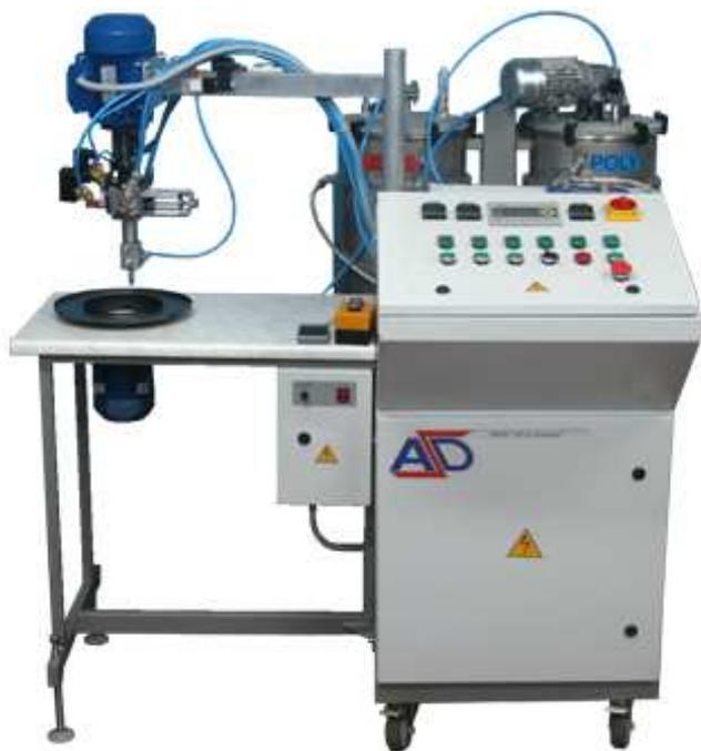
**Двухкомпонентная дозирующая машина *LP2-01*** – исполнении с шестидесятилитровыми емкостями на мобильной передвижной раме.
