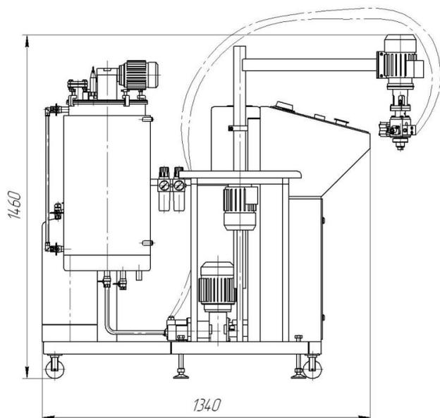
Дозирующая машина LP2-01 – исполнение с рабочим столом с поворотным устройством.
