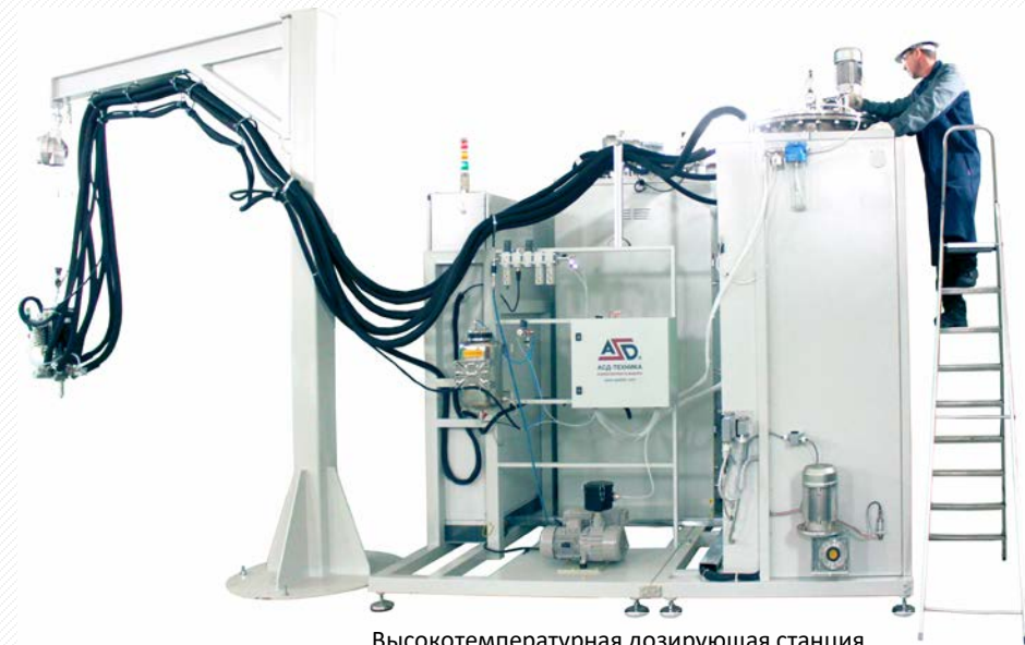
Высокотемпературная дозирующая станция с массой единичной заливки до 150 кг и более
