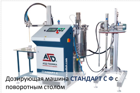
Дозирующая машина СТАНДАРТ Д Ф с поворотным столом производства фильтров с концевым диском из ППУ
