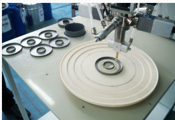
Дозирующая машина СТАНДАРТ Д МП с двухкоординатным механизмом перемещения для производства панельных фильтров
