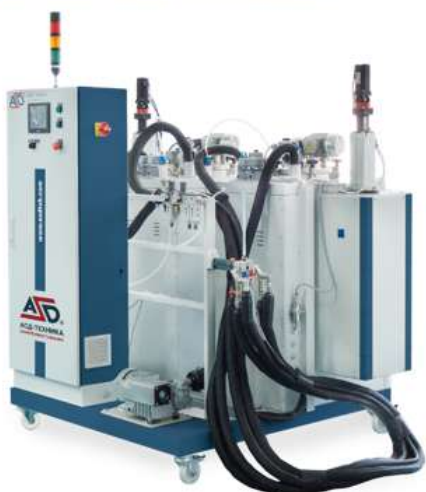
Дозирующая станция СФЕРОПЛАСТ
