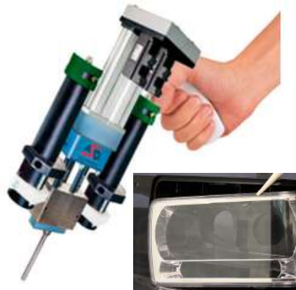
Автоматизированные дозирующе-смесительные устройства для 2К и 1К клеев из туб МИКАРТ
